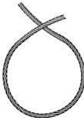
**Abb. B** Dieses Drahtseil ist geknickt. Es ist zu spät, um den Schaden rückgängig zu machen; das Drahtseil muss entsorgt werden. Es ist dauerhaft beschädigt und darf nicht mehr verwendet werden.
