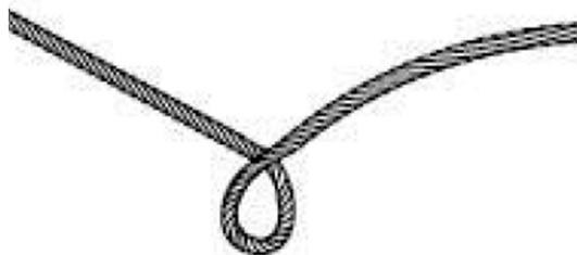
**Abb. C** Dies ist ein geknicktes Drahtseil, das begradigt wurde. Obwohl es gerade gezogen wurde, sind einige Drähte des Drahtseils gedehnt und andere stark verbogen, wenn nicht sogar gebrochen. Die ungedehnten Drähte werden stärker belastet und können plötzlich versagen, bevor das Seil seine Kapazität erreicht. Dieses Drahtseil muss entsorgt und darf nicht mehr verwendet werden.
