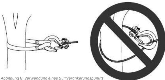
Abbildung G: Verwendung eines Gurtverankerungspunkts.
