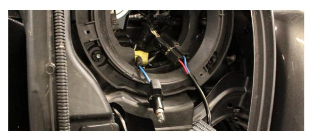
Zwicken Sie mit einer Kabelzange das Standlämpchen ab und versehen Sie die offenen Enden mit Kabelschuhen:
