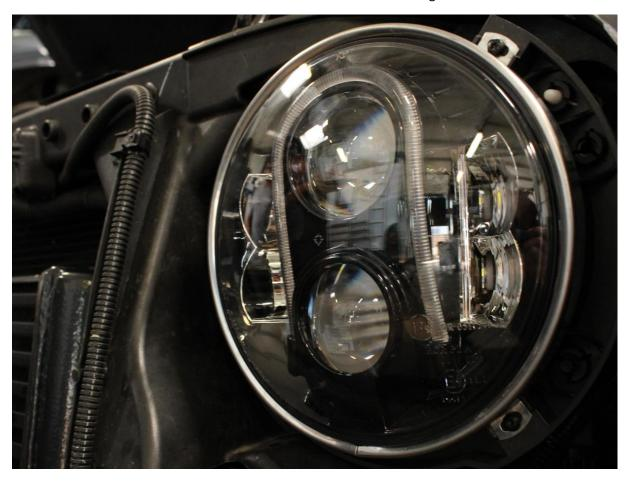
Danach den Chromring wieder festschrauben und den Frontgrill befestigen. Fertig.
