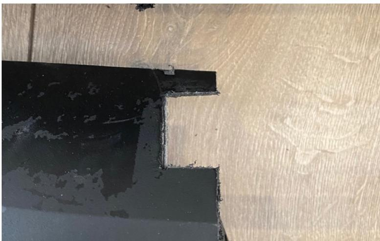
Die Kanten müssen sehr gut entgratet werden, damit die Halter ohne Spannung aufgeschoben werden können.
