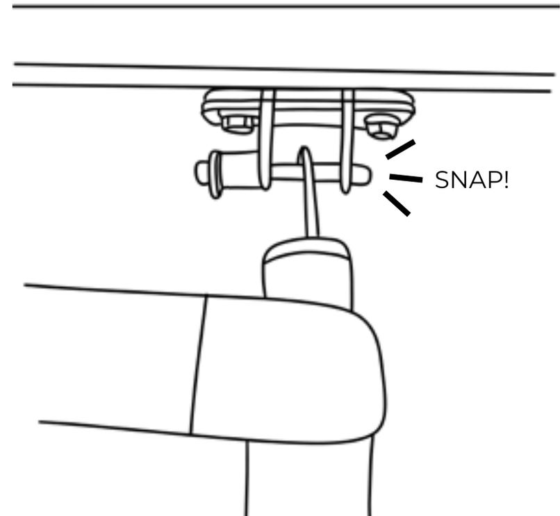
DE - Leiter auf komplette Länge ausziehen. | EN - Open the ladder completely to full size.
