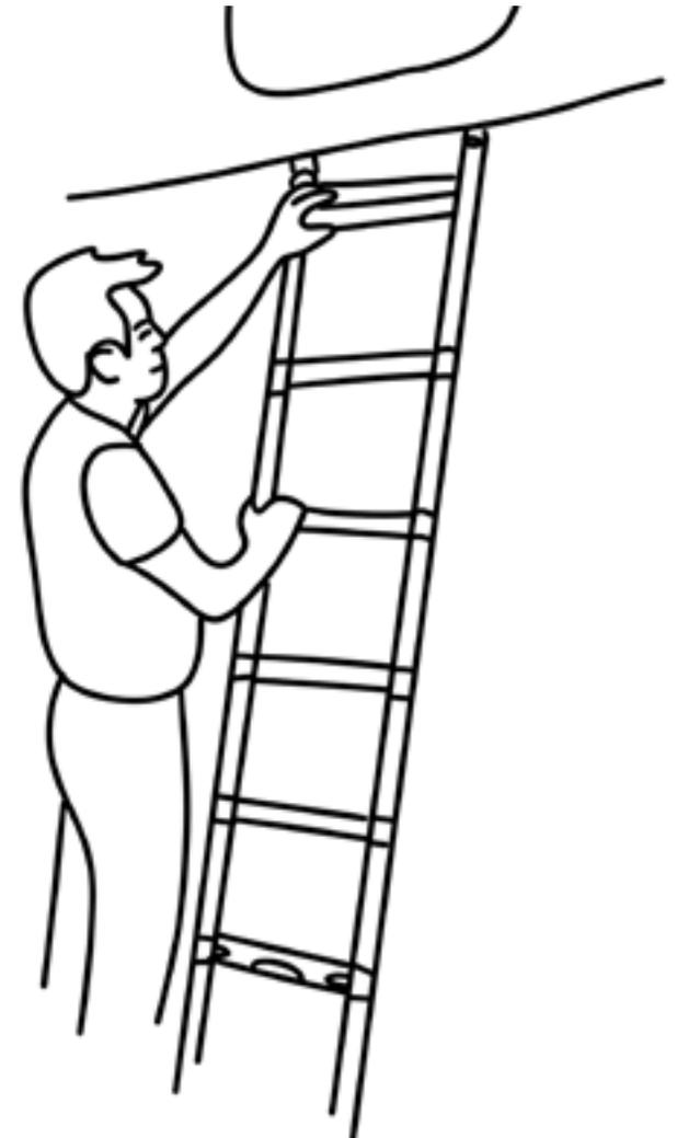
DE - Leiter mit zwei Sicherungs-Stiften am Dachzelt fixieren. | EN - Mount ladder with safety pins to the tent.
